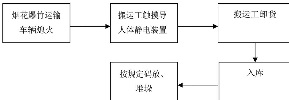
图 2.4-1 入库工艺流程图
