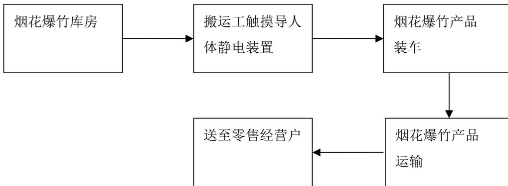
图 2.4-2 配送工艺流程图
