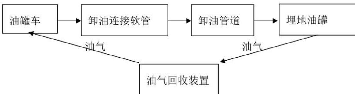
图 2.6-1 汽油卸油工艺流程图
