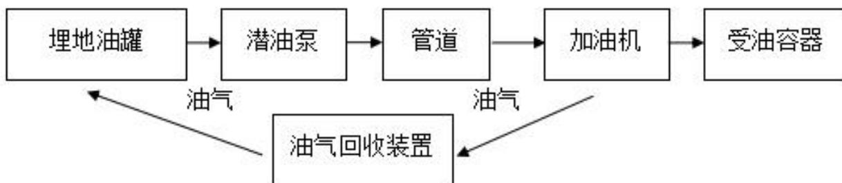
图 2.6-3 汽油加油工艺流程图
