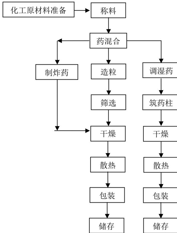
图 2.4-1 亮珠、炸药、药柱生产工艺流程图
