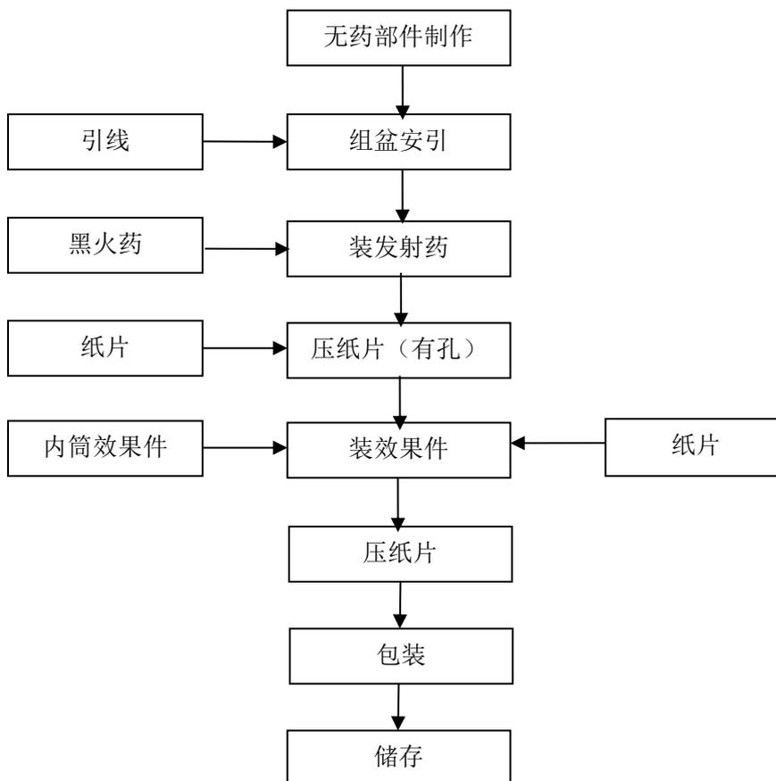
图 2.4-3 组合烟花生产工艺流程图
