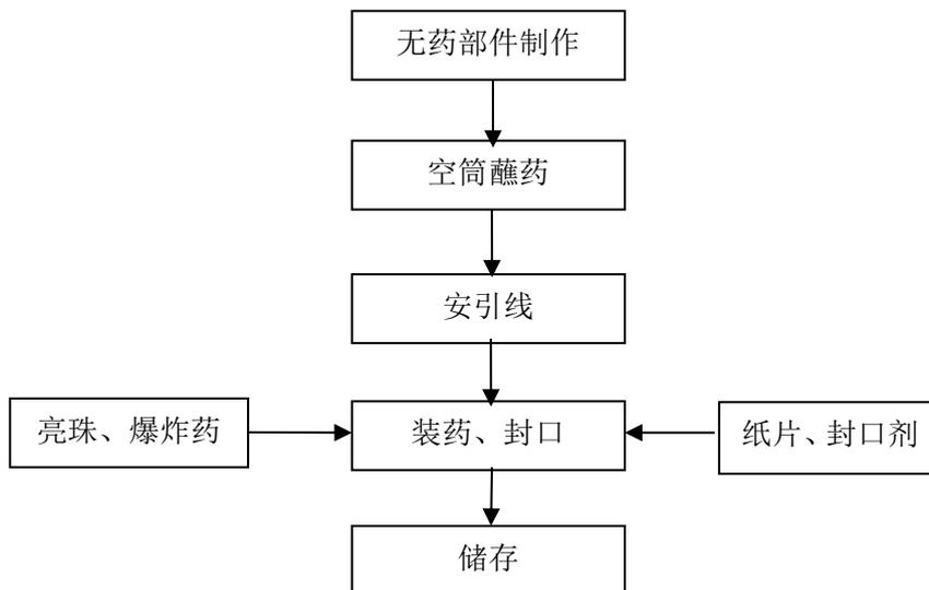
图 2.4-2 效果内筒生产工艺流程图
