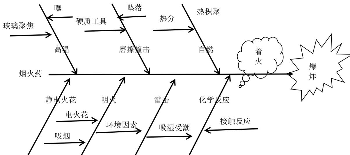
图 3.11-1 烟火药燃烧、爆炸触发条件分析图
