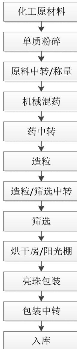
图 2.3-3 烟火药生产工艺流程图
