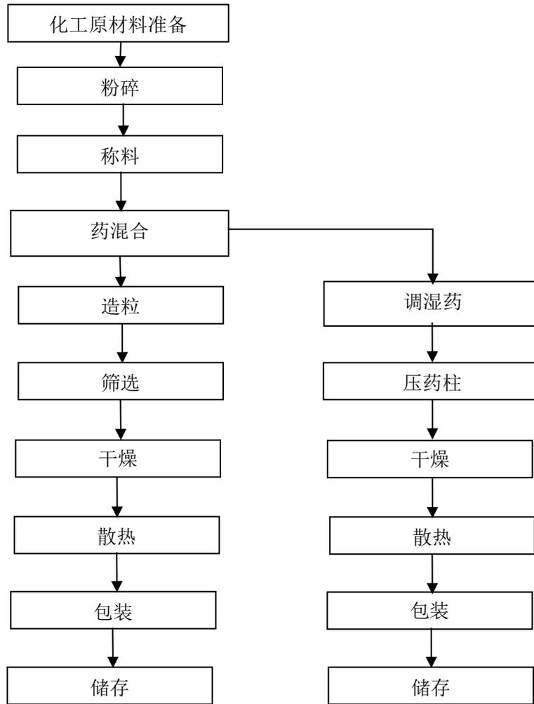
图 2.4-1 亮珠、药柱生产工艺流程图
