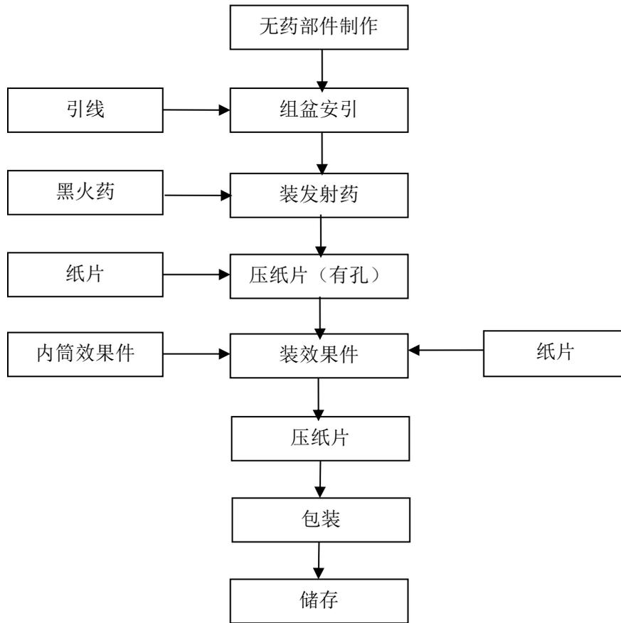
图 2.4-4 组合烟花生产工艺流程图
