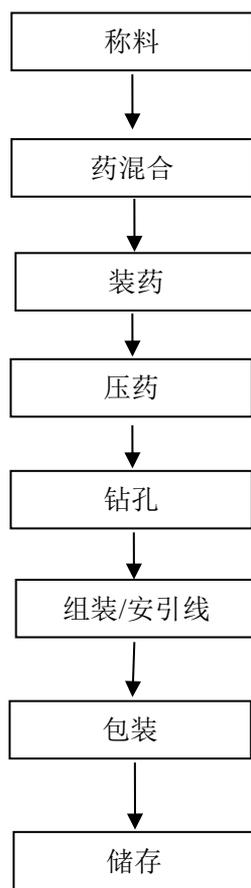
图 2.4-5 玩具类（烟雾型）产品生产流程图
