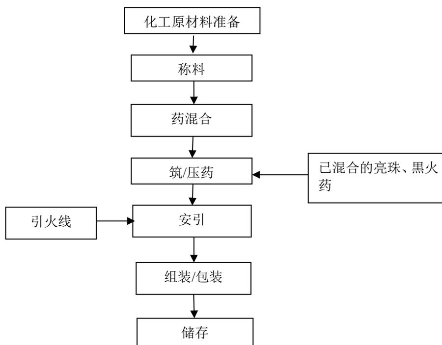
图 2.4-3 喷花类产品生产工艺流程图
