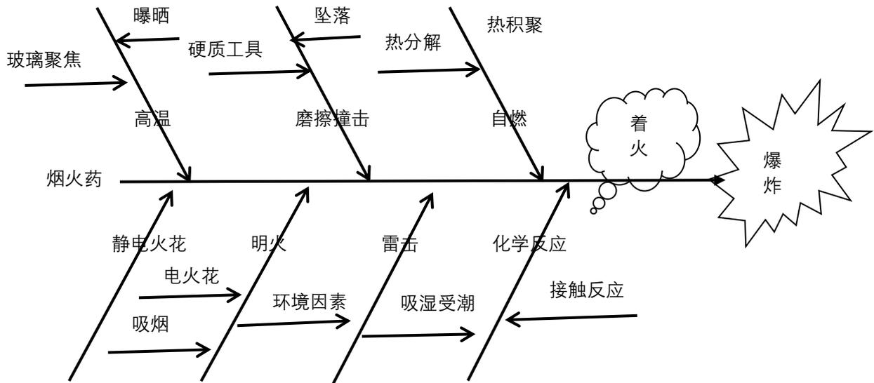
图 3.11-3 烟火药燃烧、爆炸触发条件分析图
