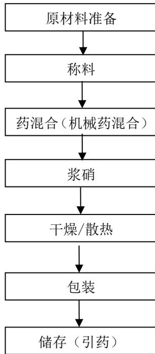
图 2.4-2 引线药生产工艺流程图
