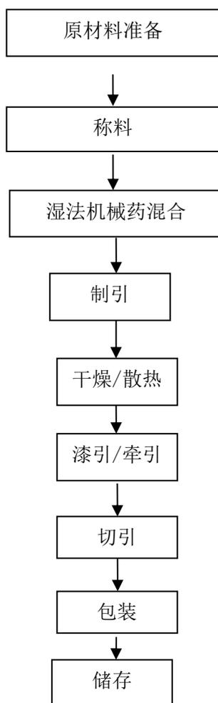
图 2.4-1 湿法制安引产品生产工艺流程图
