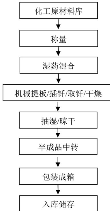
图 2.3-4：C、D 级玩具类（线香型—电光花）生产工艺流程图
