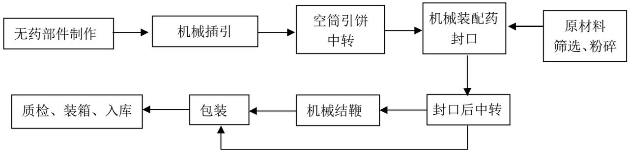
图 2.3-3 爆竹（白药炮）生产工艺流程图
