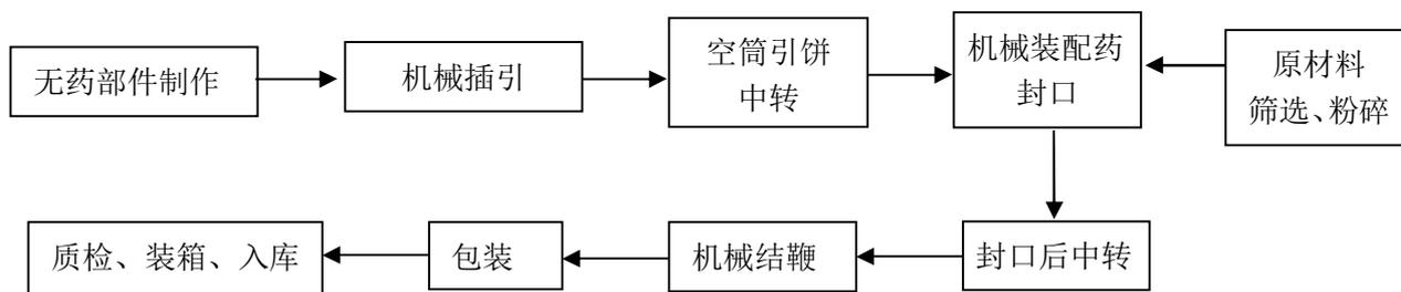
图 2-1: 爆竹生产工艺流程图
