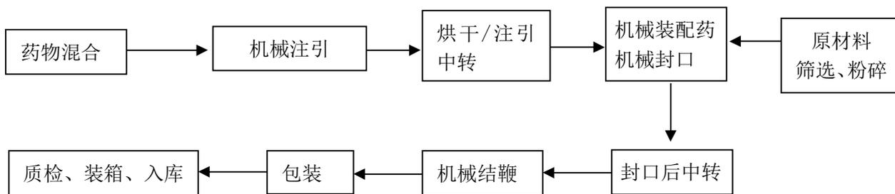
图 2-2: 爆竹生产 (注引) 工艺流程图
