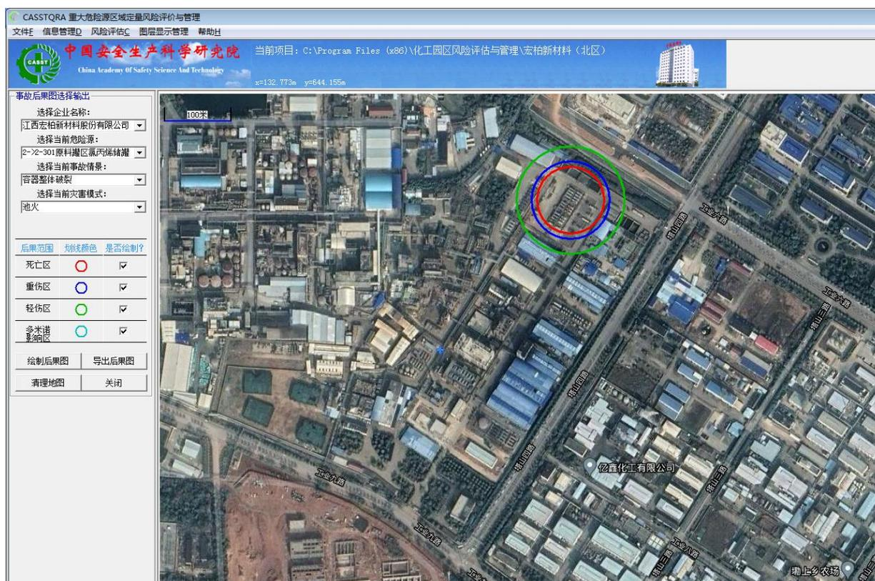
图6.2-1 氯丙烯储罐容器整体破裂或者管道完全破裂事故后果图
